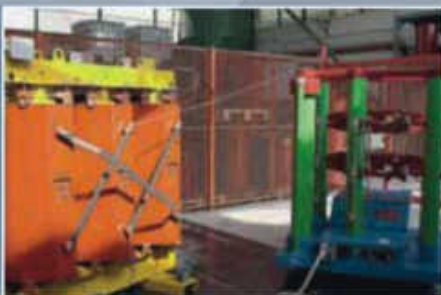
Испытание напряжениями грозовых импульсов (Типовые испытания)
